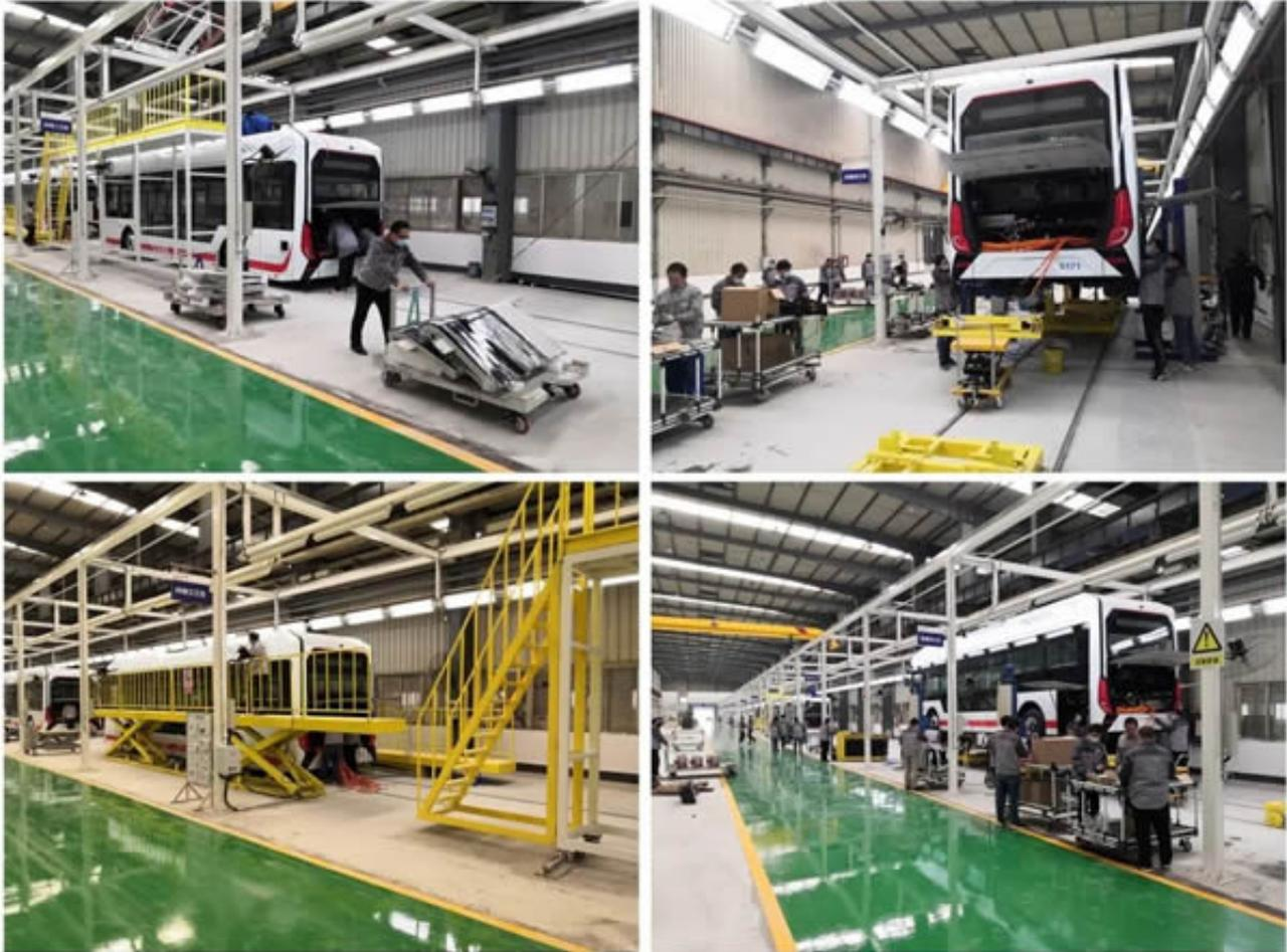
即将交付的这批10.8米氢燃料城市客车，以“氢”为动力，通过氢燃料发动机转换为电能驱动车辆运行，一次加氢只需15-20分钟，即可实现超长续航500公里。该车不仅搭载了EPB电子驻车系统、ASR防侧滑系统、电子后视镜、360°全景环视系统、前部碰撞预警系统、车辆偏离预警系统等诸多智能安全科技，有效地提升了整车的智能化程度和安全性，还采用了高端的空气悬架系统，可根据不同路况及应用场景实现车辆的上下升降及左右侧倾及一级踏步低地板，使乘客上下车更加便捷，乘坐更加舒适安心。整车具有零排放、噪音小、寿命长等优点，有力地促进了成都市的绿色公共出行和蓝天建设。
