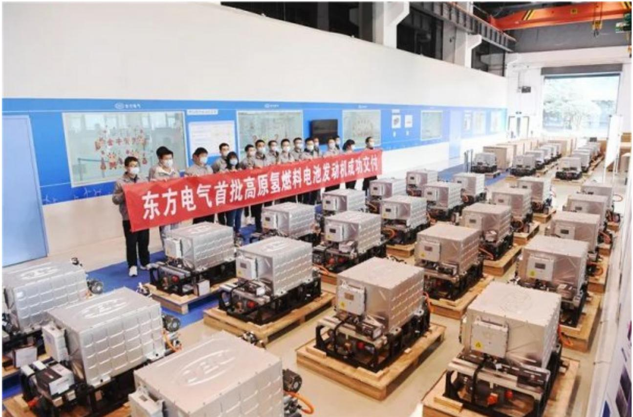
该批氢燃料电池发动机是东方电能为西昌市氢燃料电池公交示范线“量身定制”的“动力模块”，是国内第一批为高原地区自主研发设计的氢燃料电池发动机，能够在空气稀薄的高原地区长期稳定运行。据悉，该批氢燃料电池发动机的成功交付，将为西昌首批氢燃料电池公交车正式跑起来奠定坚实基础。
