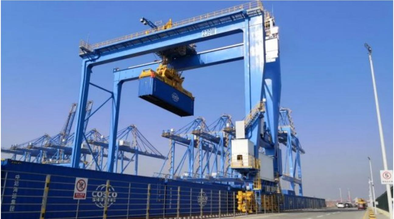
与此前交付产品的不同，为符合港口的操作习惯，便于维护和维修，氢能公司根据轨道吊的整体布局，对燃料电池发电系统采取了分体式布局，燃料电池和储氢系统从原先的组合式变成了分体式，同时对燃料电池系统的体积进行了压缩。
