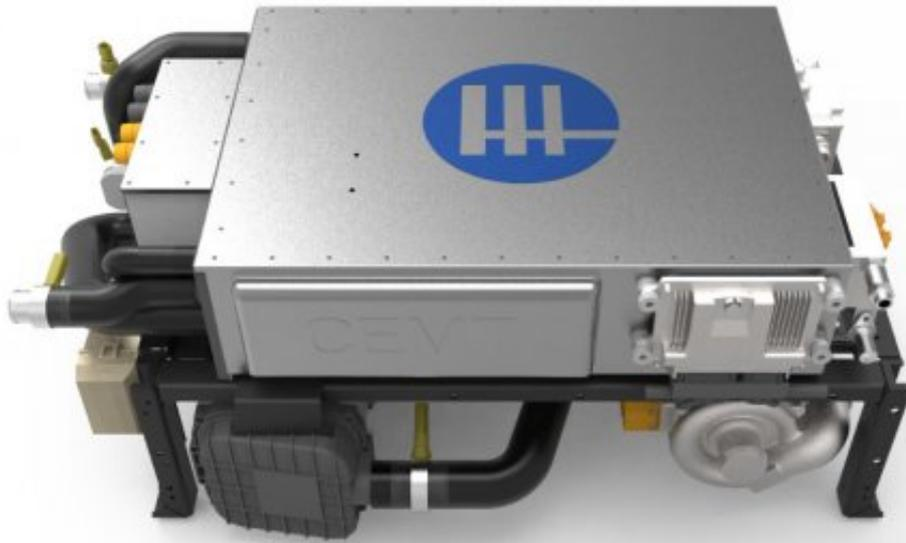
该系列的燃料电池发动机满足-40 低温存储、-30 低温启动、IP67防护等级，设计寿命 10000h，将进一步推动大功率燃料电池在旅游大巴、物流车、重卡等高速重载场景应用，助力国家实现2030碳达峰2060碳中和目标。
