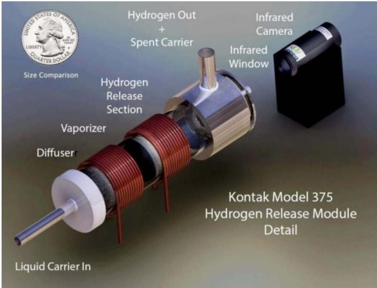
氢是地球上最环保的能源资源，它也是最丰富的。电池技术在过去几十年里有了显著的进步，但由于其体积、重量和充电时间长，目前仅限于乘用车和小型卡车。因此，氢的吸引力仍然很强。目前所缺少的是安全储存、运输和分配氢的方法。Kontak是一家位于美国西雅图的早期技术公司，它已经申请了一种新的储氢技术的专利，该方法通过化学方式将氢与液体载体结合，并在需要时安全地释放。
