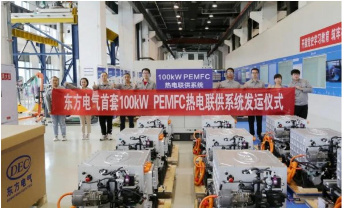
100kW级商用氢燃料电池冷热电联供系统由可再生能源制氢与固态储供氢耦合、燃料电池冷热电联供几部分组成，由东方氢能、东方锅炉与华电集团四川分公司三方联手打造，东方氢能主要承担燃料电池热电联供部分研制工作。系统发电效率大于52%，热电联供总效率超过90%，支持离网并网、孤岛运行和黑启动，同时对外提供65℃热水。该系统将打通水电制氢、氢气发电、供热制冷等环节，进一步拓宽氢能示范应用领域，开辟可再生能源制氢及氢能综合利用的新路径。
