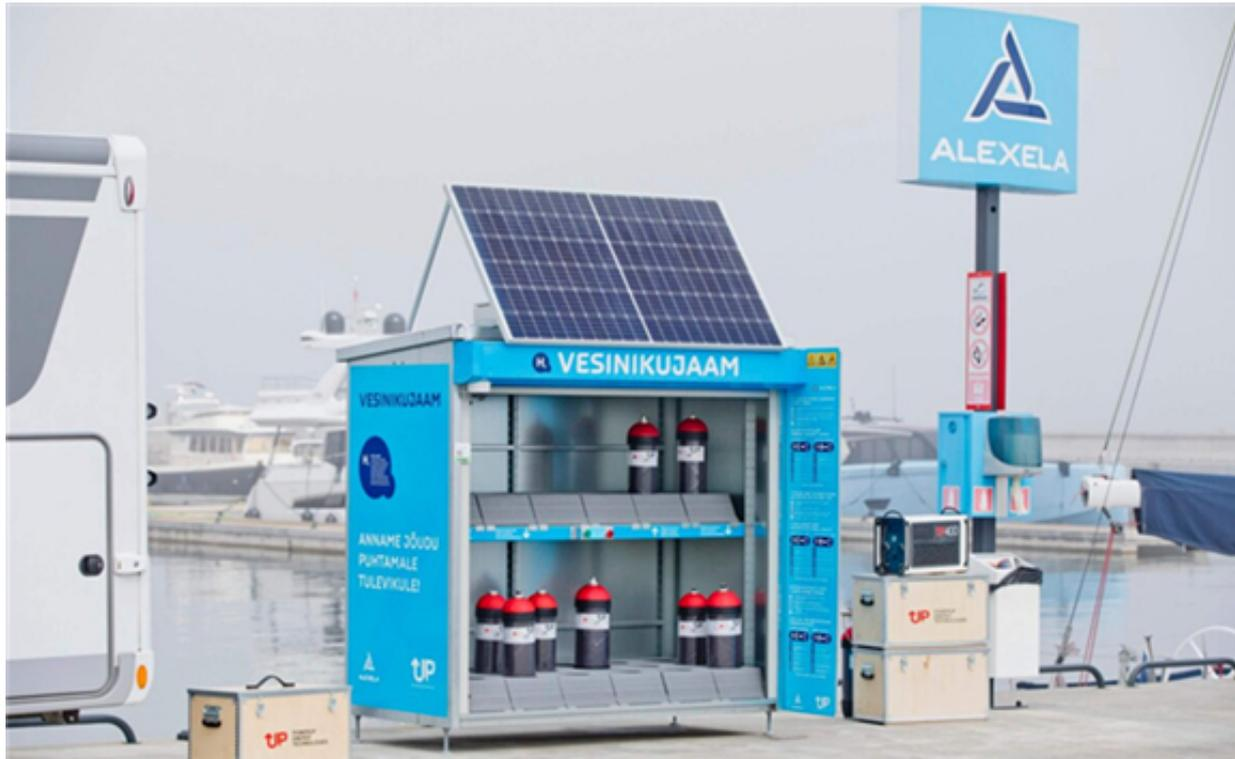
这种由太阳能电池板供电的储氢柜是一种聪明的方式，可以让水手、露营车车主或任何其他使用氢气的用户通过APP轻松租用氢气瓶。
