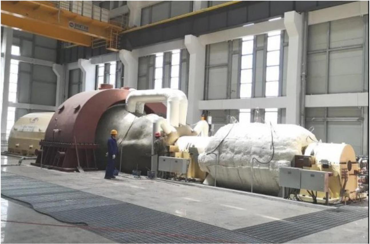
2021年6月7日14时15分，由哈电集团汽轮机公司承制的黑龙江庆翔热电有限公司庆安县农林生物质热电联产项目80 MW汽轮机组一次启动成功，性能指标优良。
