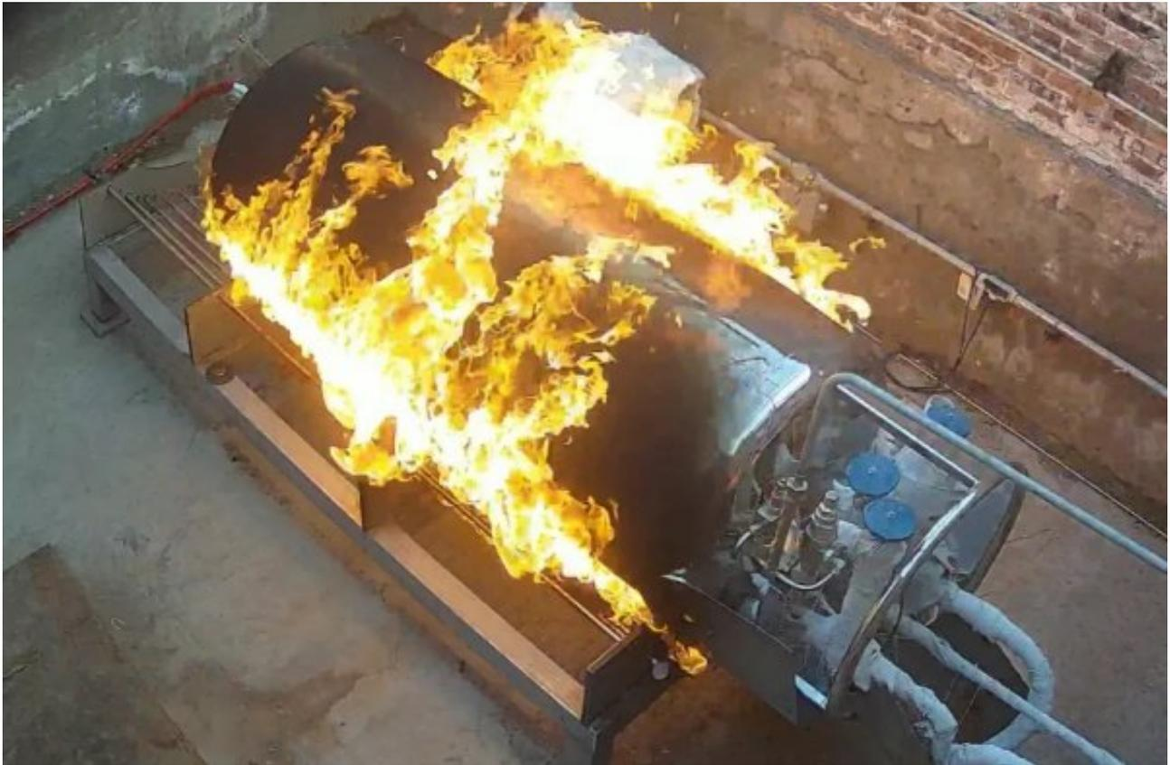
日前，北京航天试验技术研究所成功完成国内首例车载液氢瓶火烧试验。该试验瓶为高真空多层绝热结构的液氢重卡车载氢瓶，瓶内充装液氢真实介质，先后完成了蒸发率、维持时间和耐火烧性能等关键测试。本试验的成功，标志着基于我国氢能装备检测能力的进一步提升，为车载液氢瓶检测标准的制定提供了重要的参考依据。
