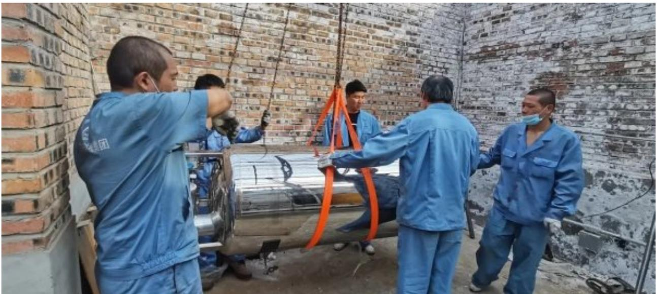
火烧试验是车载液氢瓶的一项重要试验内容，主要考核车载液氢瓶在火烧情况下压力泄放装置的工作能力和车载液氢瓶的耐火烧性能，车载液氢瓶内储存大量液氢真实介质，危险因素高，火烧试验难度大。
