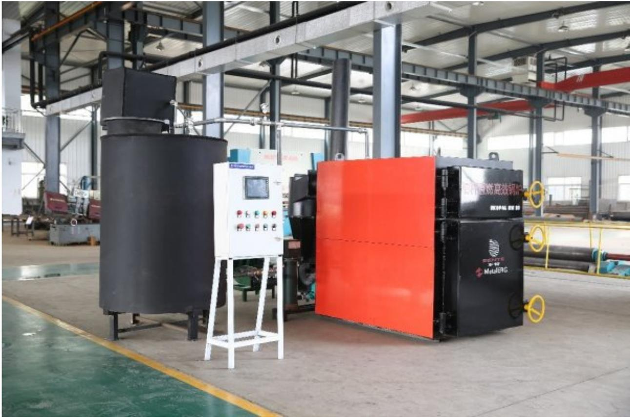
秸秆捆烧技术（又称“秸秆打捆直燃”）是将松散的秸秆打捆后在专用生物质锅炉燃烧的一种能源化利用技术，是北方农村清洁供暖的有效技术路径，具有成本低、原料适应性强等优点。针对秸秆捆含土量高、锅炉热效率低、氮氧化物和颗粒物排放高等问题，研发玉米秸秆打捆一体化关键技术装备，构建可持续供应体系；研发了秸秆高效低氮捆烧、烟气中颗粒物减控脱除等关键技术，研制出秸秆捆烧清洁供暖技术装备，显著提升了供暖锅炉的燃烧效率和智能化协同控制水平。
