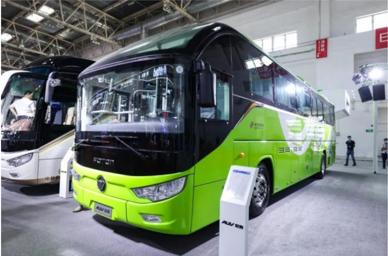
在展会现场，欧辉BJ6122氢燃料客车亮相，该车采用150kW大功率燃料电池发动机，搭载70MPa氢系统、全气候耐极寒动力电池及双电机无动力中断驱动系统，以出色的环境适应能力著称。
