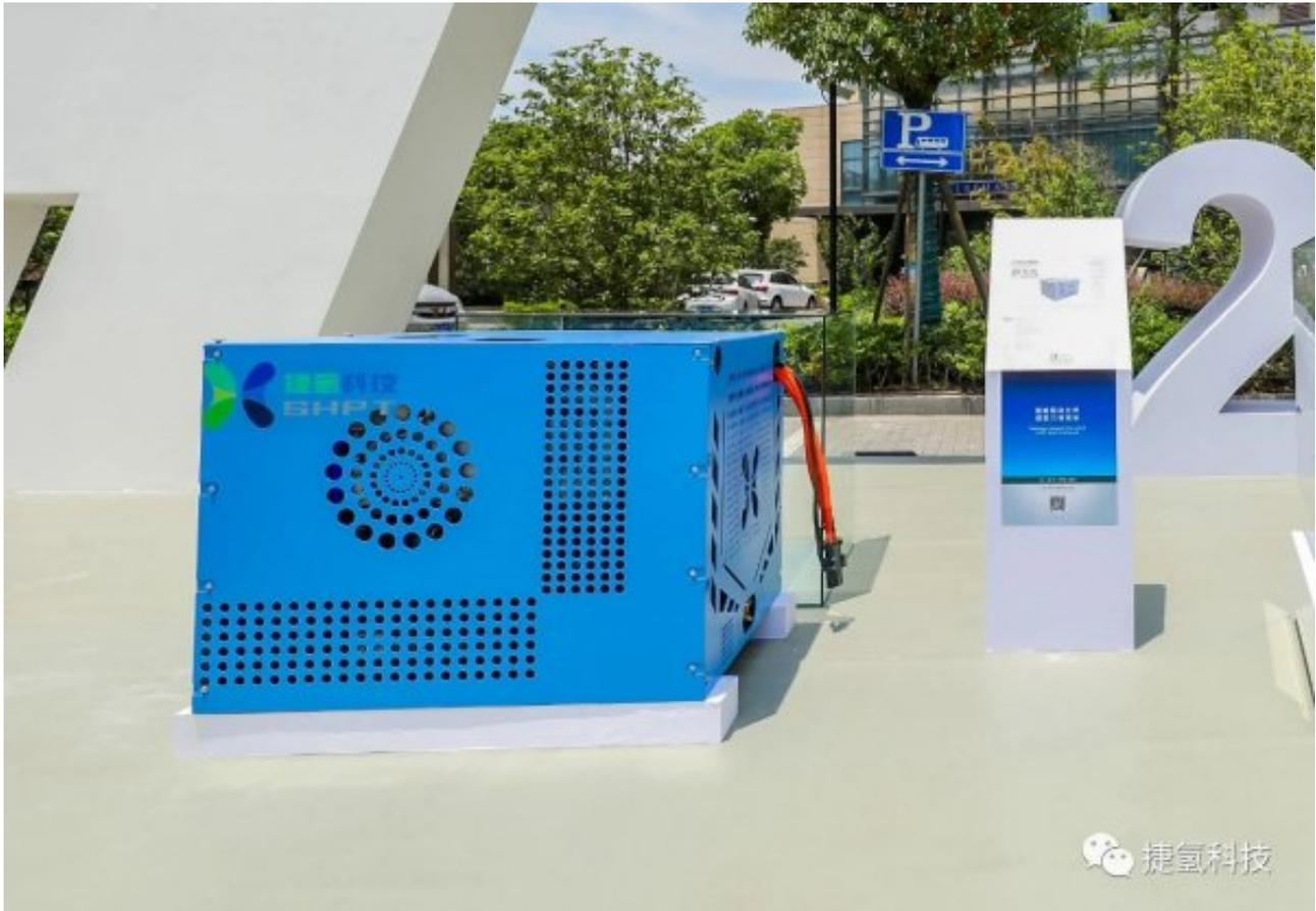
PROME P3S系统集成了燃料电池系统、动力电池以及储氢系统，可应用于2t~8t燃料电池叉车、机场拖车及微型车上。系统额定放电功率可以兼容6kW-25kW的应用场景，峰值功率为55kW。此外，该系统可在-30 -43 的环境下安全工作。
