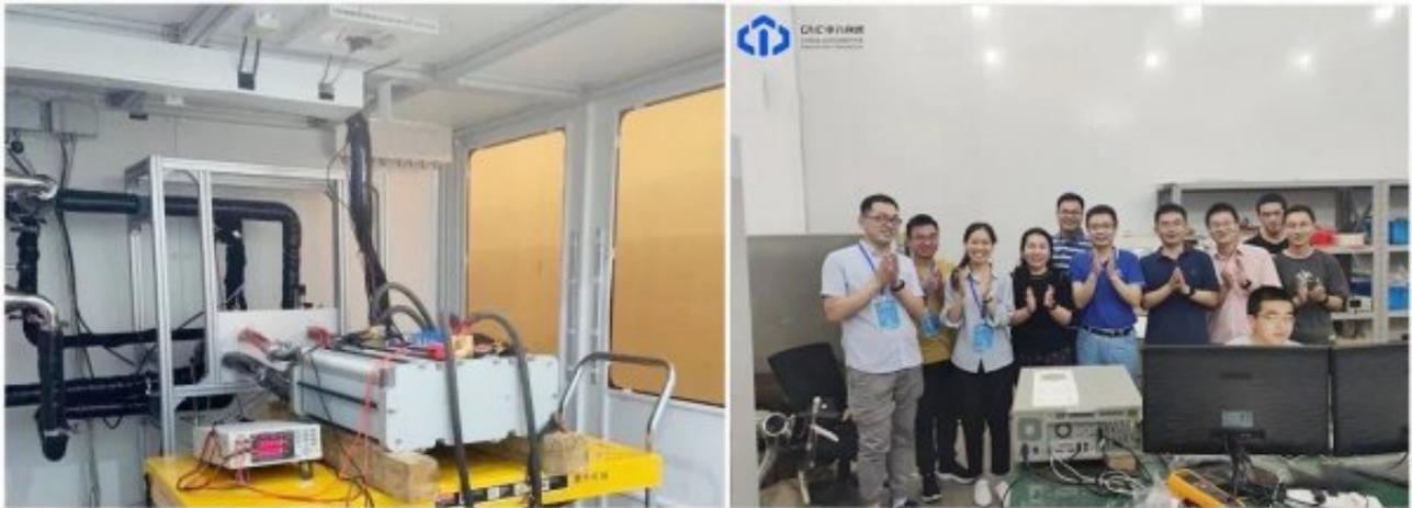
参与测试的这台燃料电池电堆是由中汽创智自主研发设计，具有自主知识产权，掌握和攻克了多项核心技术的全功率电堆。电堆采用注塑一体化端板制造技术，在保证电堆性能和强度的前提下，精简了电堆结构，优化了电堆装配方案。
