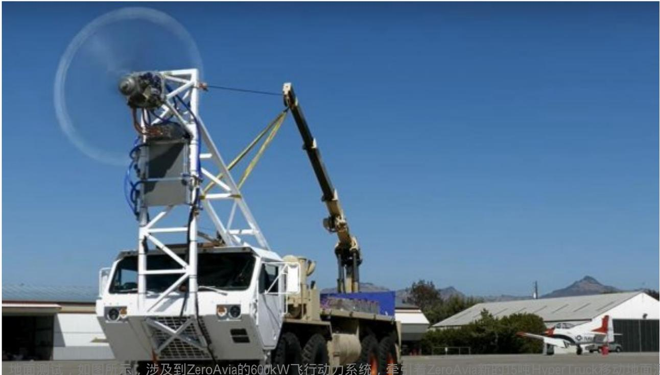
地面测试。如图所示，涉及到ZeroAvia的600kW飞行动力系统，牵引着ZeroAvia新的15吨HyperTruck移动地面测试平台穿过停机坪。
