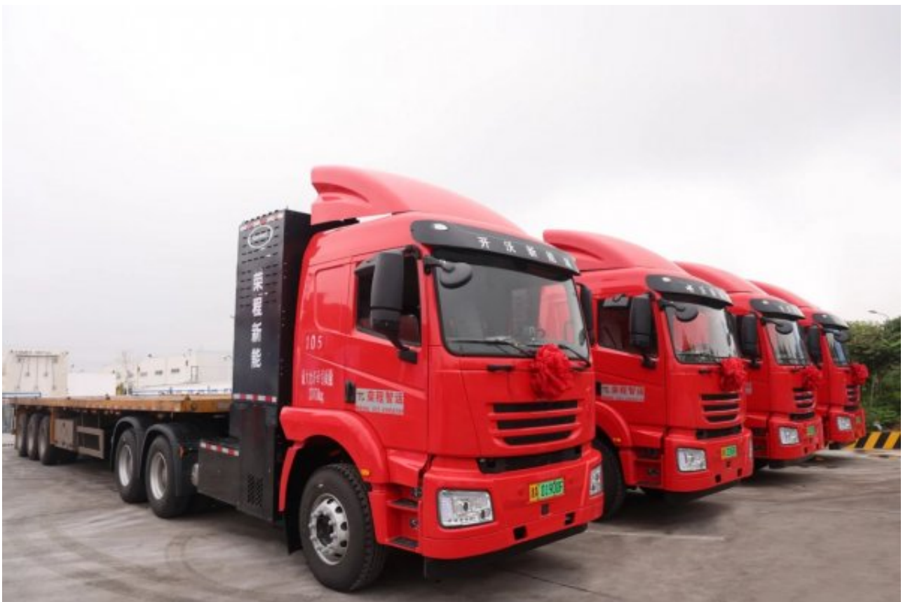
荣程氢燃料电池重卡由开沃汽车生产制造，是国内领先的燃料电池牵引车。汽车搭载氢燃料发电系统由天津新氢动
