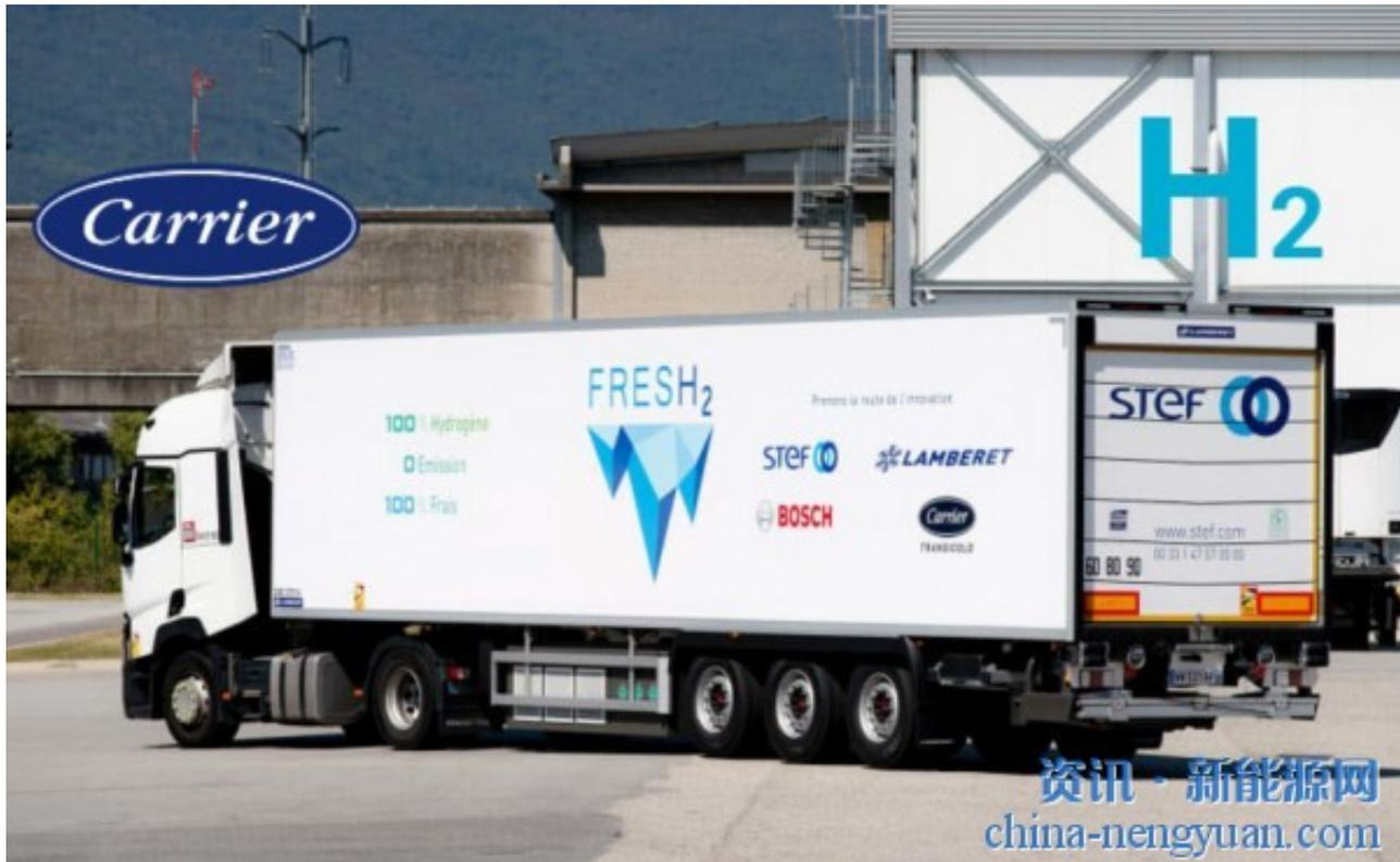
使用替代燃料的可持续运输不仅出现在卡车上，也出现在冷藏拖车上。Transporter Stef与博世(Bosch)、Lamberet和Carrier Transicold合作伙伴正在启动FresH2项目，该项目中的冷却系统由燃料电池供电。
