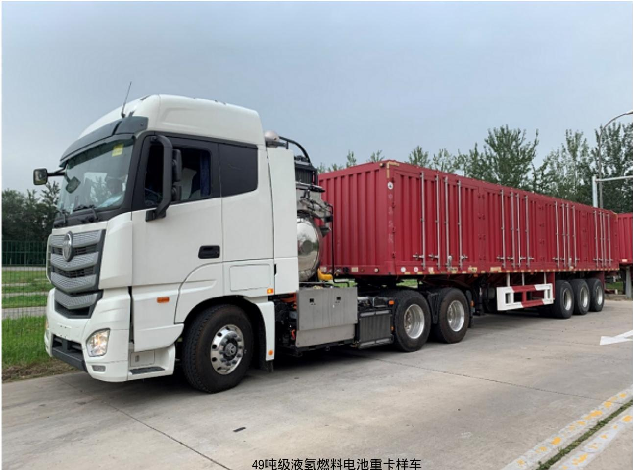
49吨级液氢燃料电池重卡样车
