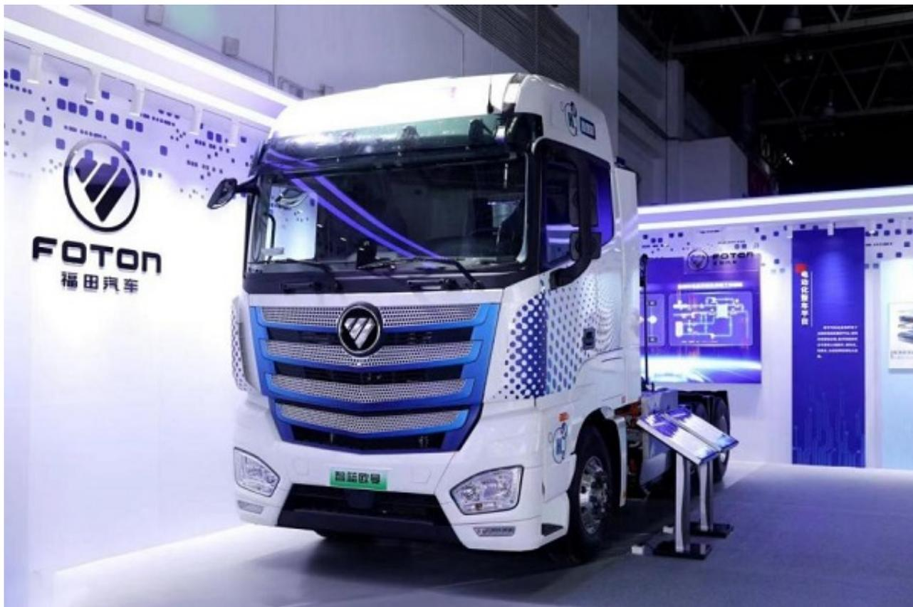
福田欧曼氢能重卡采用全新底盘架构，具有高效率、高集成、长续航、轻量化等突出优势，在多项关键技术方面取得重要突破。攻克了车载液氢存储系统核心技术，首次将液氢应用于车载燃料电池储氢系统，填补了我国车载液氢燃料电池技术空白。相较于气氢储供系统，同体积下携氢量增加了近3倍。整车平台采用分布式驱动，攻克了重载大扭矩电动轮关键技术，采用了4台额定功率80kw轮毂电机驱动，峰值扭矩可达15000N·m以上。同时，面向重载大功率动力系统需求，研制了100kW大功率燃料电池系统，高功率动力电池系统可满足10C放电能力，车辆动力系统峰值功率达500kW以上。燃料电池余热与液氢汽化水热管理相结合，福田欧曼氢能重卡可在-30℃下一键启动，可满足车辆全天候运行，拓展了氢能重卡在国内北方大部分地区的冬季应用场景。
