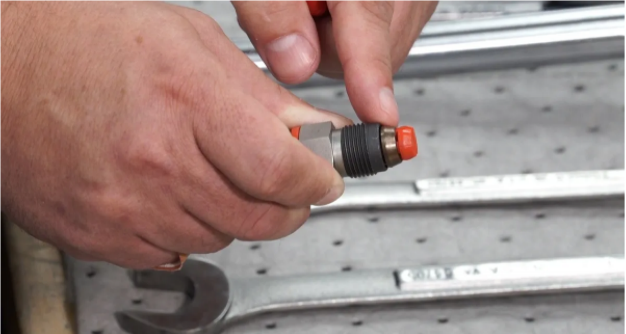
图3.为便于组装，预组装的FK系列接头盒包括一个公螺母、两个套圈和一个可拆卸的塑料心轴，可安装到接头主体的母端口中。
