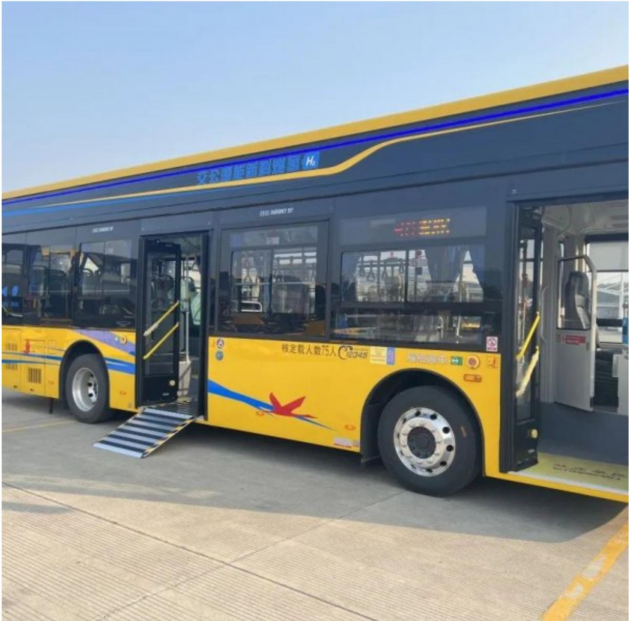
公交车上还有很多暖心人性化设置，以备不时之需。车辆低入口设计和上下车导板，结合ECAS升降系统充分考虑到了行动不便的乘客，方便他们安全上下车，轮椅也通过这个坡道快捷地进入车厢；车内配有USB接口，可以手机充电；红外传感器防夹、一键破窗器、一键报警、氢泄露检测系统等智能安全配置，也可减少意外的发生，有效提高安全防范。
