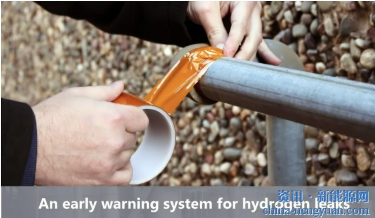
日东公司(Nitto)的氢气检测胶带是一种独特的技术，一旦暴露在氢气中，就会永久改变颜色，从而可以凭借视觉直观的检测氢气泄漏。
