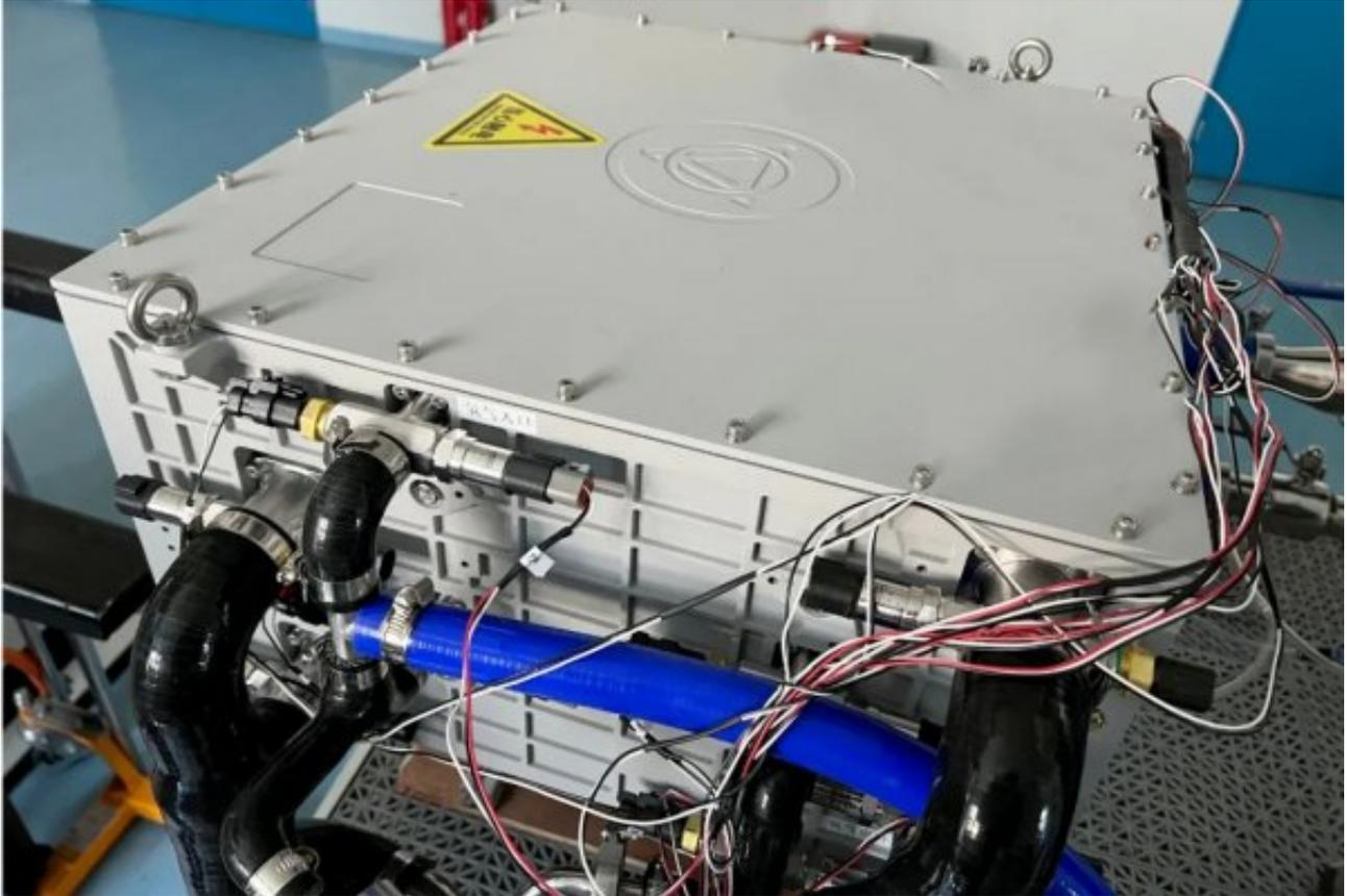
在《燃料电池电动汽车示范运行测试规范》中，燃料电池的额定功率是指在平均单片电压0.60V时的功率；按此规范，该双堆燃料电池模块的额定功率超过220kW，模块的体积功率密度达到2.6kW/L，模块中每个单堆的额定体积功率密度为4.4kW/L。模块中除包含2个金属板电堆外，还有电压巡检模块和必要的机械及电器部件。
