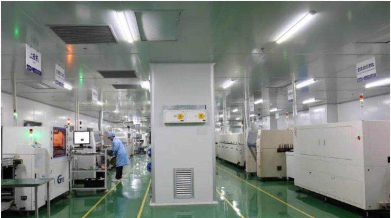
为确保生产品质，昇辉新能源以高标准的原则采购一系列生产设备，配置进口回流焊及知名品牌波峰焊，设备采用美国AB变频控制波峰马达转速和运输速度，确保DC/DC电路板的可靠性。在DC/DC变换器装配车间，昇辉新能源采用高标准精益化布局，搭配先进的流水插件线、流水生产线、自动测试系统等检验设备，能够有效保证DC/DC变换器的质量。
