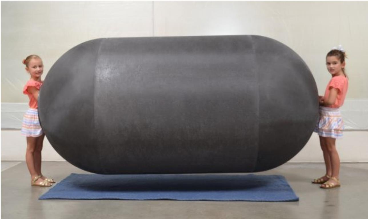
如图所示的BHL™Cryotank长2.4米，直径1.2米，重12公斤。当加入裙架和真空杜瓦瓶壳时，系统总重量为67公斤。这个特殊的储罐系统可以储存超过150公斤的液态氢，使它的储氢比至少达到50%(储存的氢燃料的重量相对于系统总重量)，是目前最先进的储罐的10倍。一架装备了GTL储罐技术的飞机，在使用航空燃料的情况下，飞行距离可以达到传统飞机的4倍，飞机的运营成本可削减约50%。
