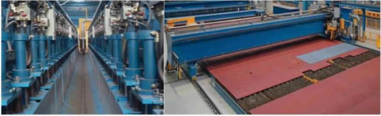
平板对接焊（16kW 大功率激光器）
