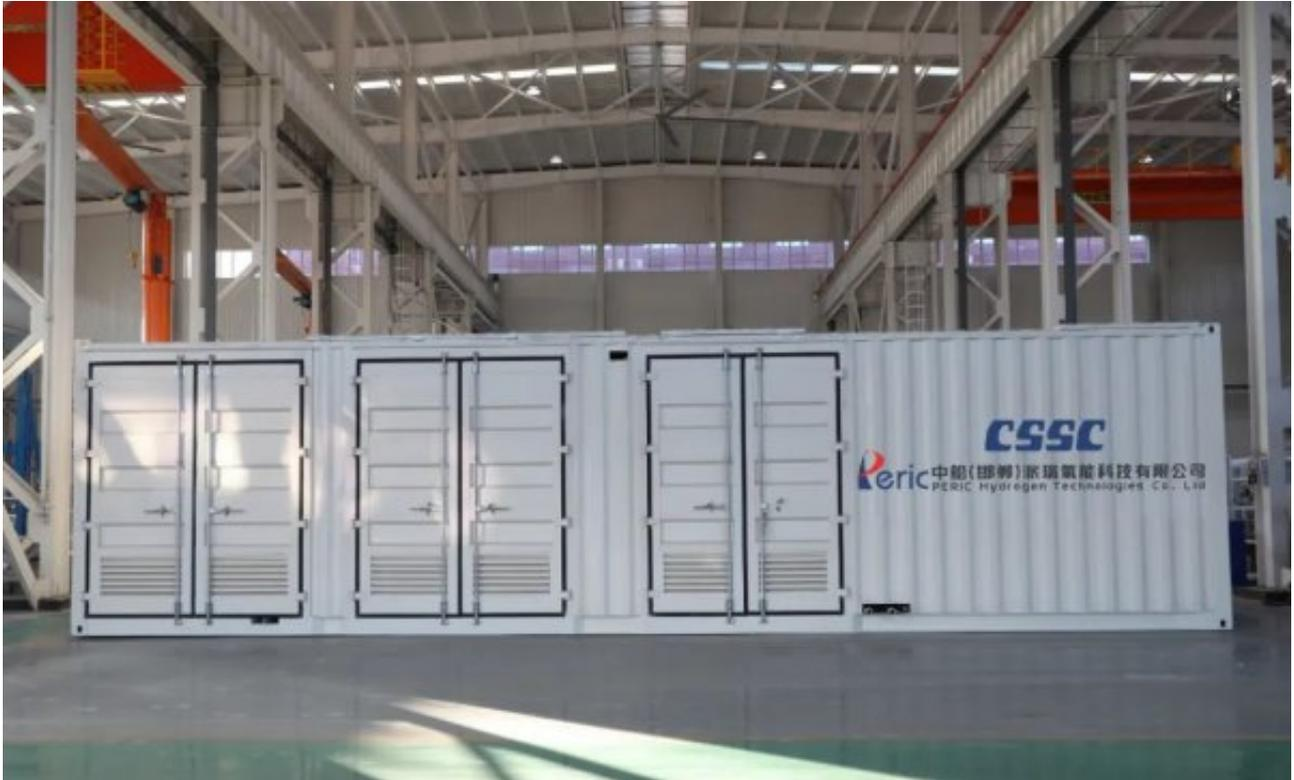
该设备是由派瑞氢能公司自主研发生产，集电解槽、气液处理器、纯化设备、控制柜、整流柜、变压器于集装箱内，具有土建量小、便于安装和移动等优点。设备调试完成后，只需要接入水、电、气即可随时随地制取氢气。
