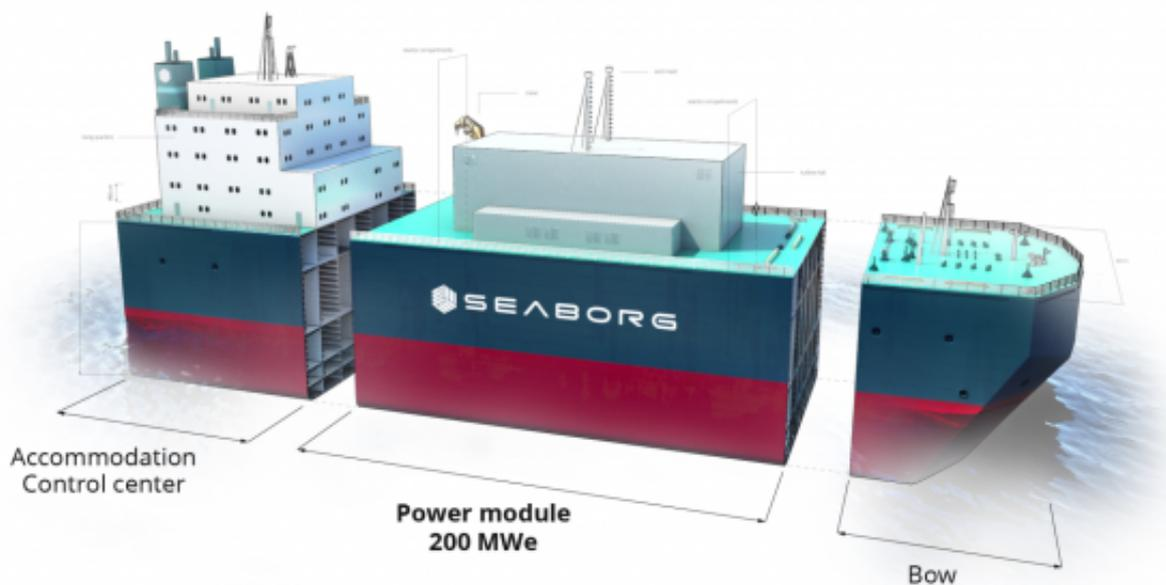
浮动式核电站的设计是模块化的，可提供高达800兆瓦(MW)的电力，使用寿命为24年，无论它是接入现有煤炭港口的电网，还是用于氢和氨发电，都具有成本竞争力。
