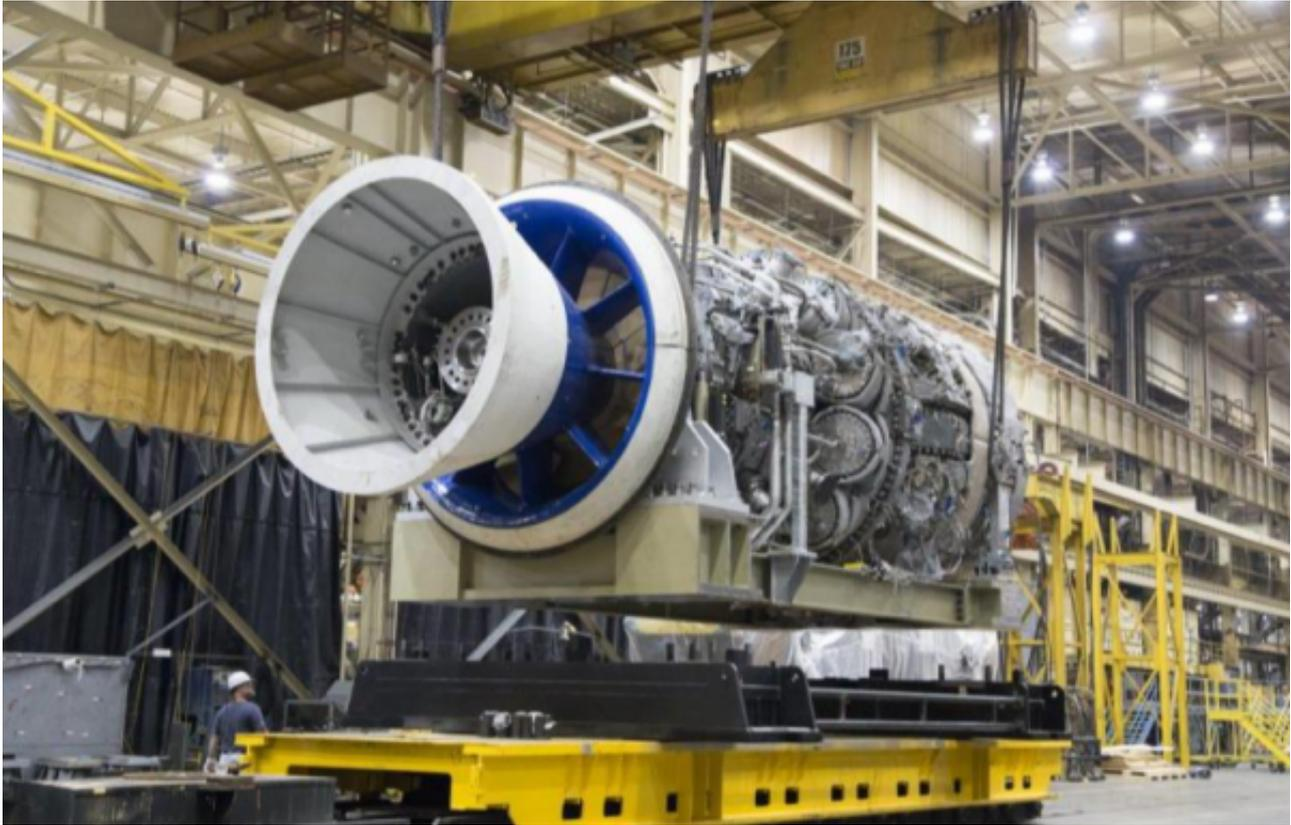
Long Ridge Energy终端由GE 7HA.02燃气轮机发电，最初可以燃烧15-20%的氢气，随着时间的推移，预计可以燃烧100%的氢气。
