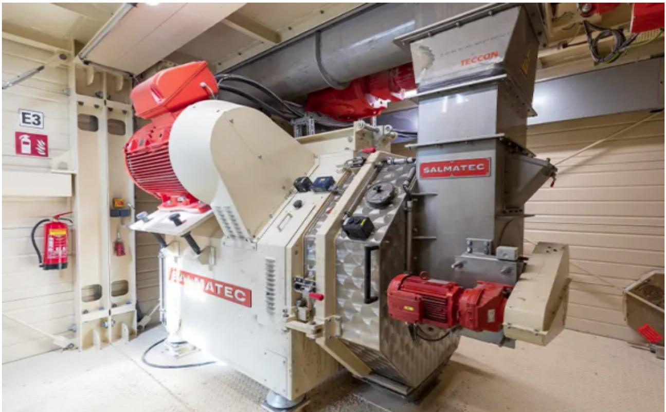
Salmatec制粒机在第三层。从制粒机中出来，颗粒通过第二层的Tecon逆流流化床冷却器，然后在Tecon滚筒式筛分机中筛除的细颗粒，这些细颗粒再循环回在第二层的进料仓。
