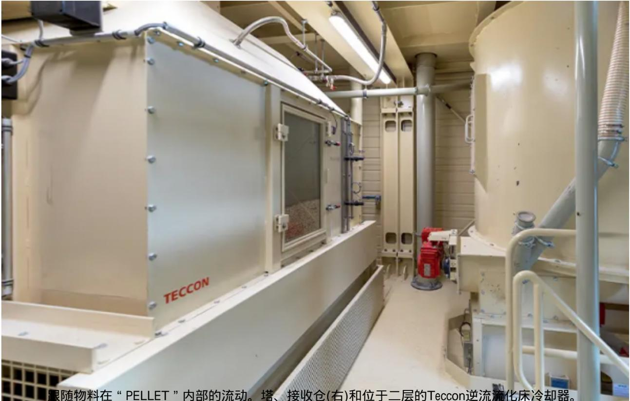
跟随物料在“PELLET”内部的流动。塔、接收仓(右)和位于二层的Tecon逆流流化床冷却器。
