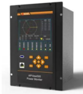
APView500电能质量在线监测装置集谐波分析、波形采样、电压暂降/暂升/中断、闪变监测、电压不平衡度监测、事件记录、测量控制等功能为一体。能够满足110kV及以下供电系统电能质量监测的要求，广泛适用于化工、钢铁、冶金、医院、数据中心、交通建筑等行业的电能质量监测。
