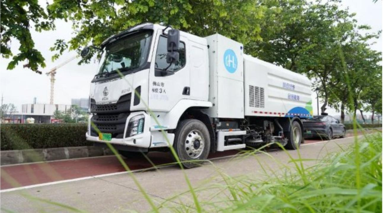
此次由佛山瀚洁负责招标的141台氢燃料电池市政环卫车共计9款车型，属于广东城市群首年氢车示范推广项目的一部分，具有交付时间紧、数量大、车型多样化等特点。广东清能作为该批车辆配套最多的燃料电池系统企业，首年共参与了7款车型的开发，动力系统采用清能成熟的二代量产产品，包含80kW及110kW两款系统型号，核心零部件的生产及组装均由广东清能负责，实现本地自主研发与配套。
