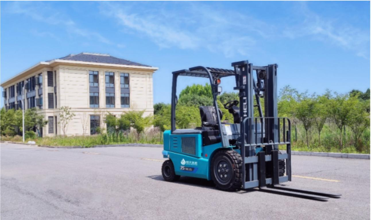
该3.5T叉车配套的动力系统是明天氢能为叉车产品开发的专用燃料电池系统，额定功率16kW,峰值功率可达到22kW，满足工业车辆对燃料电池系统要求。此前，明天氢能已开发了多款商用车燃料电池系统并实现应用，这款燃料电池叉车的下线，实现了在氢能工业车辆领域应用的突破。
