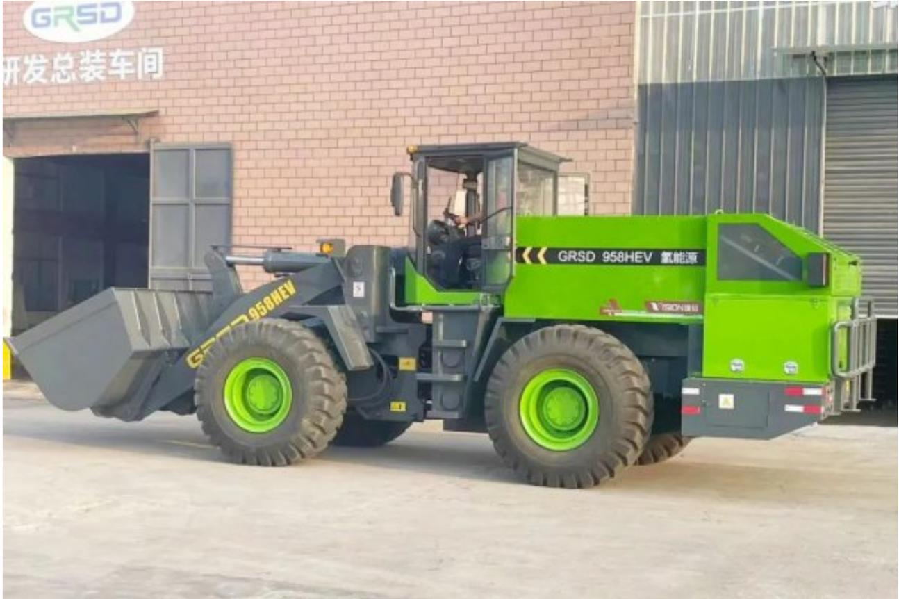
该氢能装载机为重型装载机市场的主力吨位，额定载质量5吨。配备雄韬氢雄发动机系统，配置840L氢瓶，加氢耗时低于8分钟，可连续作业6小时。
