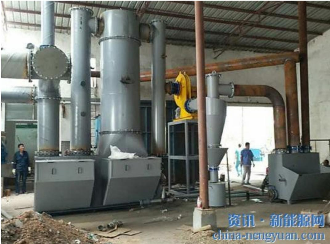
该客户是一家食品厂，有一台6吨蒸汽锅炉，因为该地无集中供气管网，响应环保号召结合当地多种农林生物燃料情况，综合考察国内生物制气设备情况，优中选优最后选用海琦生物质气化炉实行炭气联产，生物制气做为锅炉用能，产后炭渣销售给用炭企业，售炭收入基本抵消原料成本，叁个月即收回设备投资，每天节能燃料成本3万余元。
