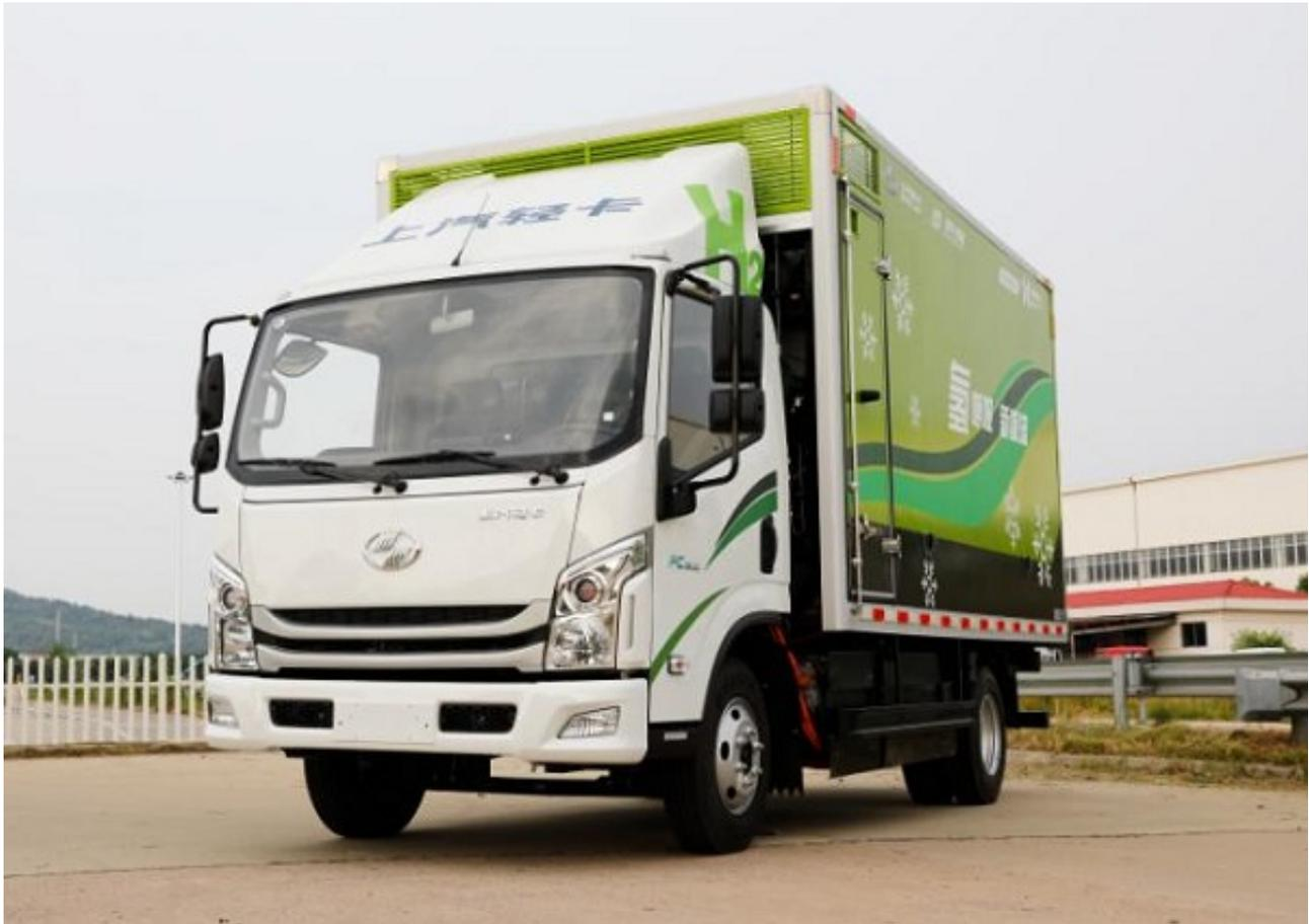
此次交付的上汽轻卡超越FC300-D4.5氢燃料电池车为F类冷藏车，外观硬朗、性能卓越，整车尺寸5990×2300×3280，是合规蓝牌轻卡的典范，其冷藏箱容积15m<sup>3</sup>，标配变频低功耗冷机，满载最大爬坡度大于20%，可全面满足城市快递，冷链和城际快运需求。新品采用捷氢科技自主模电极92kw燃料电池系统和3个35pma储氢系统，加氢时间5-8分钟，储氢量11.1kg，并搭载14.9kwh高充放功率型锰酸钾电池作为储备动力。上汽轻卡超越FC300-D4.5在40公里等速工况下续航600公里，满载全工况运营续航320公里，百公里消耗仅3.4kg。每行驶一公里，可减少碳排放1.53公斤。在可预见的未来，上汽轻卡超越FC300-D4.5有望全面引领一线城市的零碳绿色物流市场，为鳞次栉比的上海弄堂或静谧清幽的北京胡同街区，带来更加高效、环保的配送服务。
