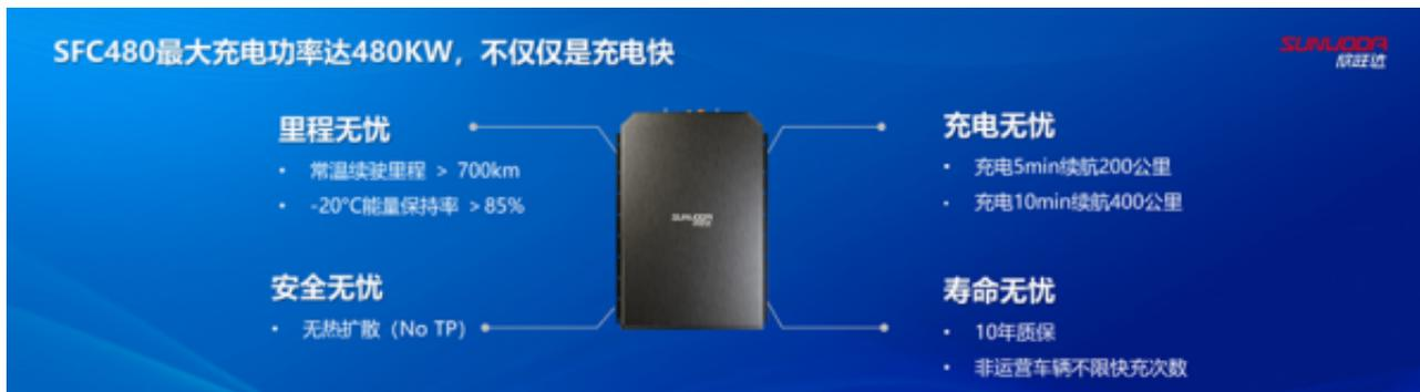
超级快充电池SFC480的硬核“欣”技术，在于材料体系创新和电池工艺创新以及关键结构创新。创新的叠加赋能本次发布的超充产品能做到-20摄氏度的低温下能量保持率高于85%，体积利用率大于72%，且可做到无热扩散。
