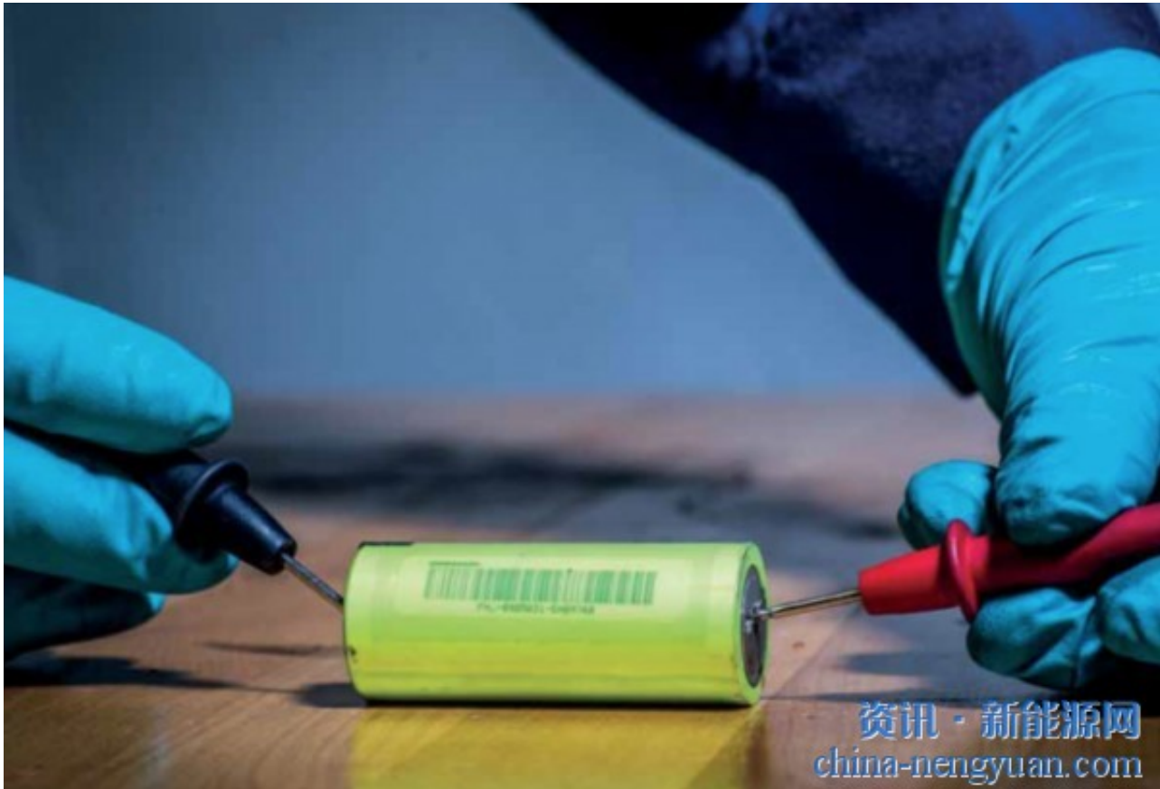
电池单元测试，DNV提供独立验证的测试数据。图片：DNV
