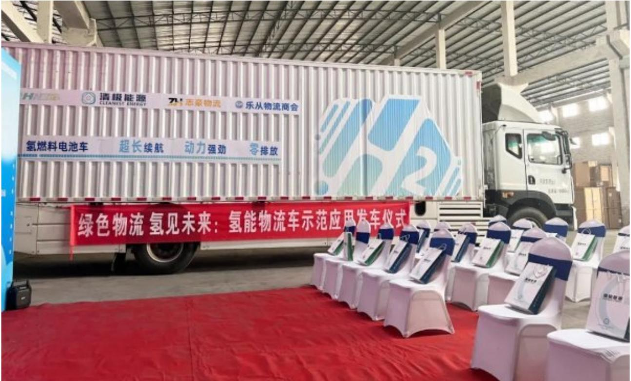
此次运营车型为18吨氢燃料电池翼展厢式货车，车身总长近12米，货厢总长度近9.6米，搭载清极能源102kw大功率氢发动机，同时配套宁德时代大容量动力电池，能长时间续航。
