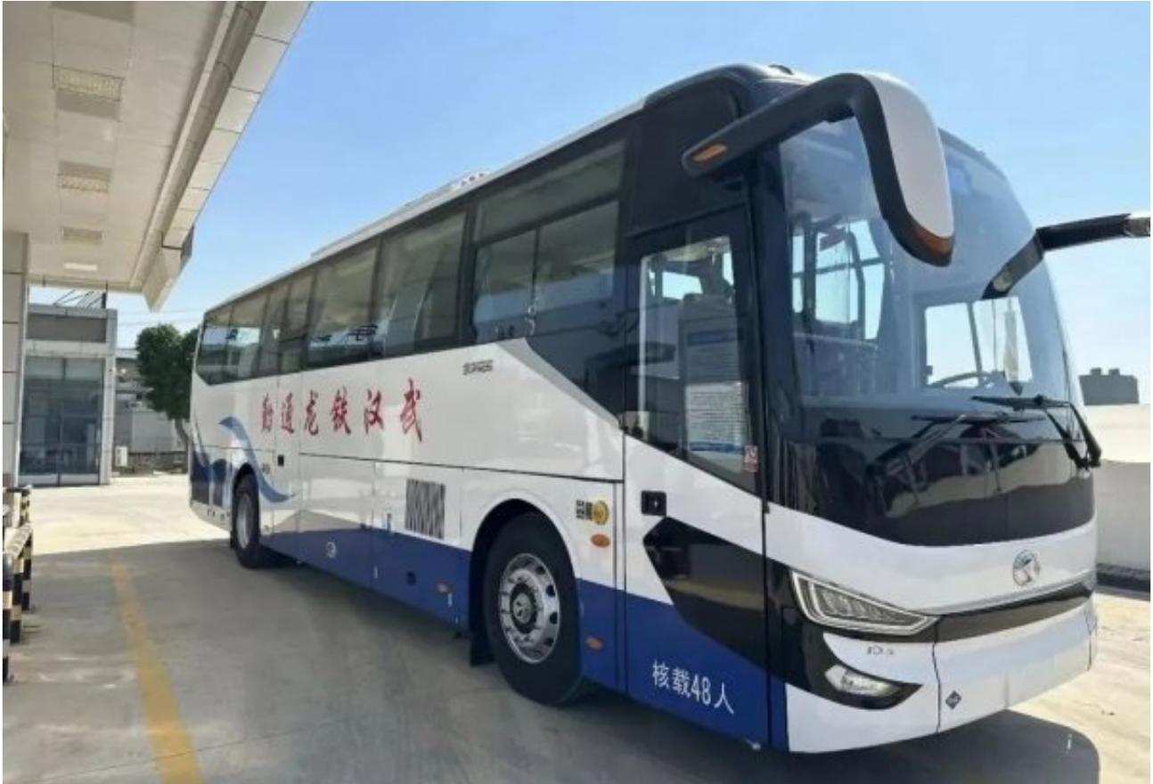
在武汉众宇&铁龙加氢站，一台崭新的金龙牌氢能源通勤车加完氢气后，缓缓驶出加氢站，奔赴通勤接驳服务现场。该车为厦门金龙联合汽车工业有限公司生产的11m、48座氢能源高级客车，搭载众宇自主研发生产的TWLQ系列车用燃料电池系统，额定功率95kW，起步稳、提速快、能效高，零碳排放、低噪音，可在-30℃下启动运行，十分钟左右可加满氢气，可行驶500km左右，唯一的排放是水。
