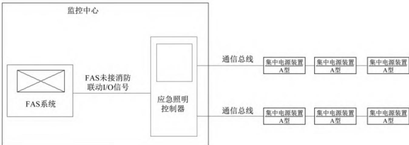
图 5 采用总线通信时的系统图
