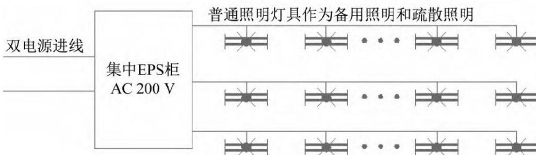
图 1 普通照明灯具兼用作备用照明和疏散照明
