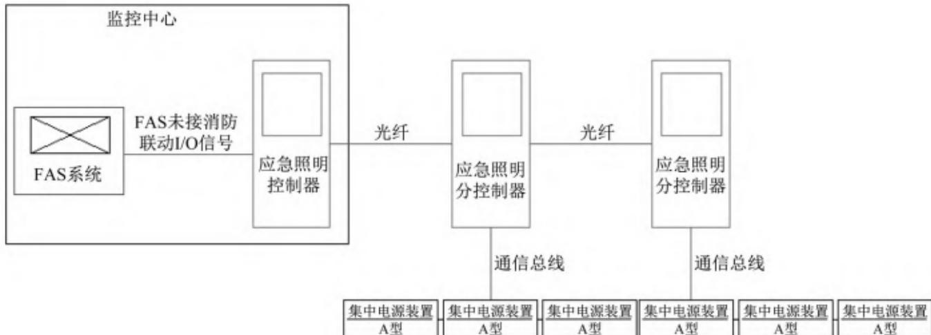
图 4 采用光纤通信时的系统图
