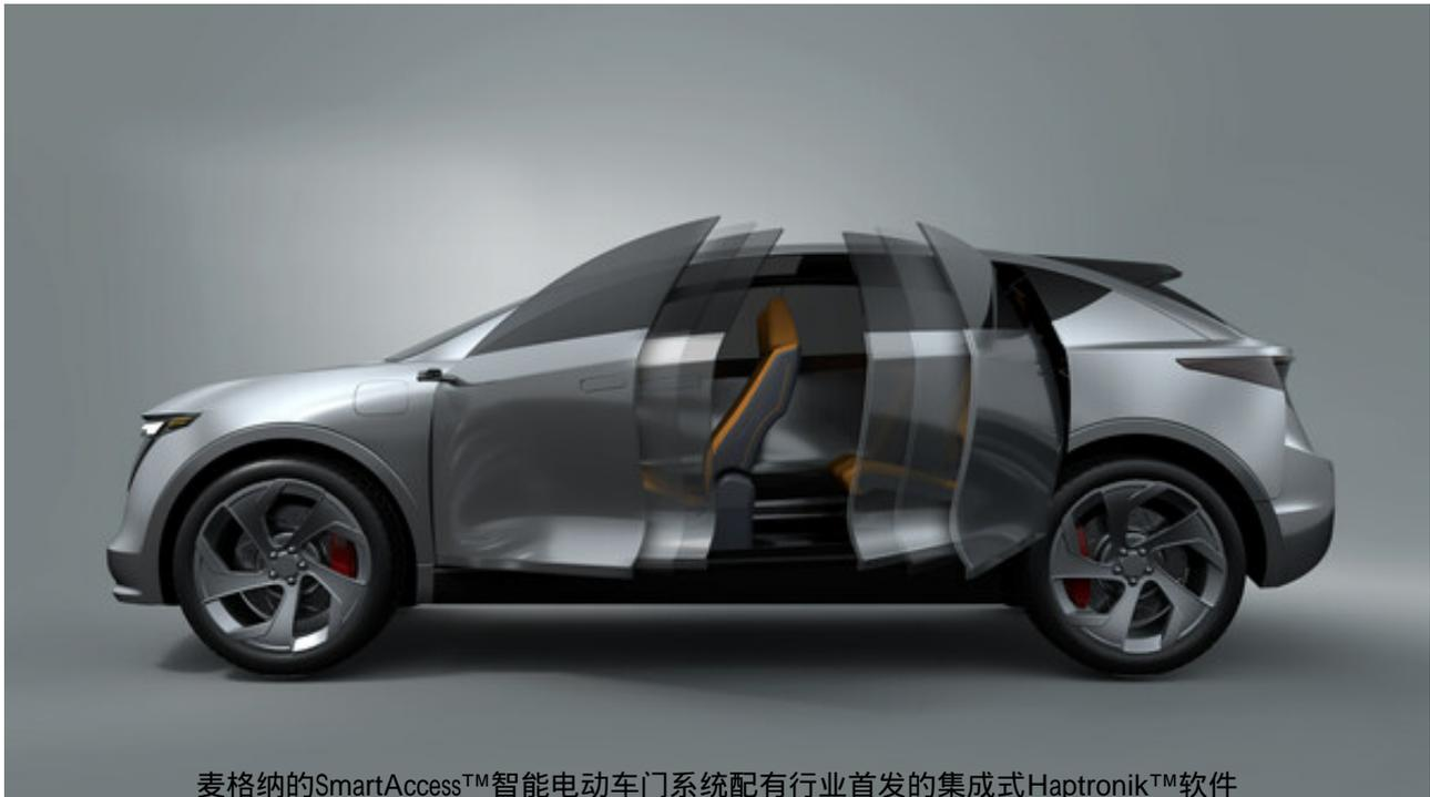
Haptronik™是一款创新的运动控制软件，它能够优化车门开合时的触感，从而令车门自如地开启和关闭。它可以检测出汽车是停在路边还是山坡上，随后根据重力自动调整。这样可以在任何地形中，都能让车门平稳地开启和关闭。除此之外，该软件还带有防撞击和防风功能。
