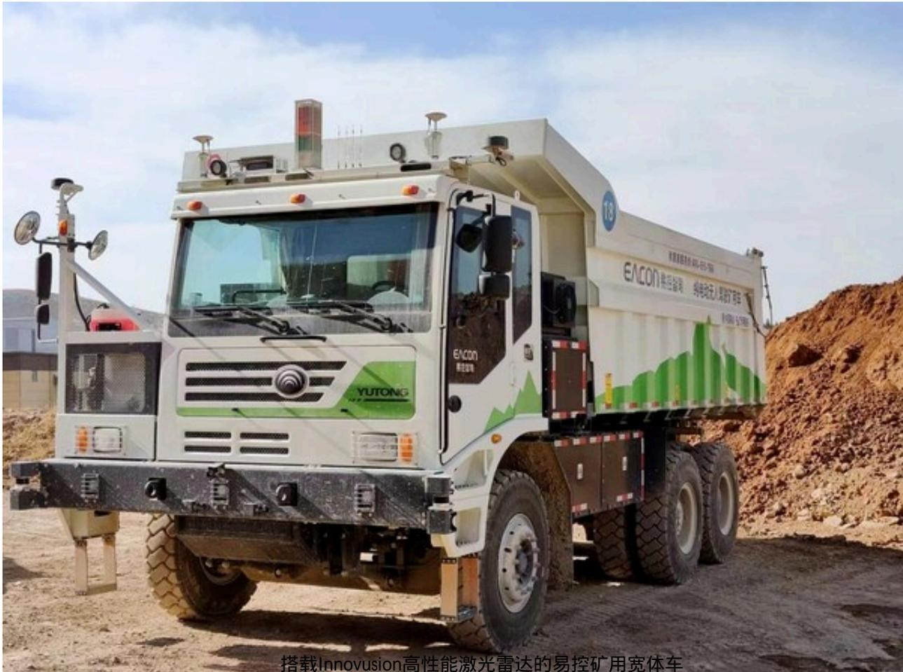
搭载Innovusion高性能激光雷达的易控矿用宽体车
