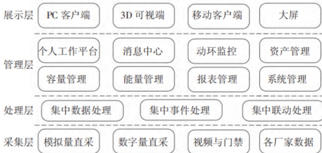
图3动力环境集中监控平台软件架构图
