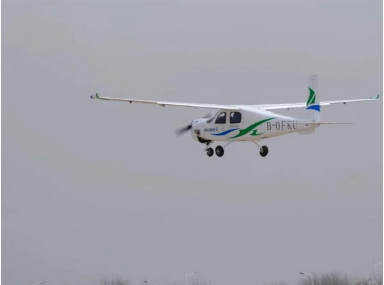
该飞机是在辽宁省科技厅“四座氢内燃机飞机验证机研制”项目资助下，沈阳航空航天大学组织辽宁通用航空研究院自2021年开始开展项目研制工作。在辽宁通用航空研究院研制的“锐翔”系列电动飞机的基础上，辽宁通用航空研究院和一汽研发总院、哈尔滨工业大学、天津大学、联合汽车电子有限公司、北京理工大学、天津内燃机研究所（天津摩托车技术中心）、北京久安通氢能科技有限公司等单位密切合作，组成以杨凤田院士领衔的技术团队开展氢内燃机在航空应用方面的论证，并基于一汽集团研发的“红旗”2.0L零排放增压直喷氢内燃专用发动机进行航空适应性设计升级，开展了以该发动机为动力的四座氢内燃飞机验证机的研究工作。
