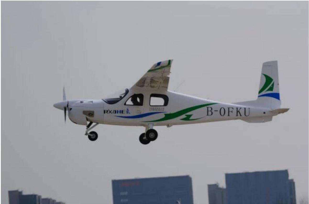
飞机采用上单翼、低平尾、前置螺旋桨、前三点式不可收放起落架的布局形式；飞机翼展13.5米，机长8.2米，使用高压气态储氢，储氢重量4.5kg，巡航速度180km/h，氢内燃机最大热效率大于43%，综合热效率大于40%，留空时间大于1小时。
