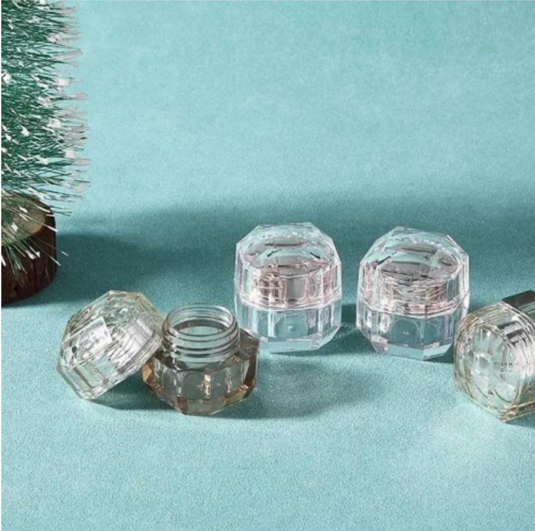
而护肤品瓶在注塑生产中是非常典型的，它兼具了厚薄注塑及透明注塑的共同特征。本套方案中，MK6 PRO注塑机应用PETG制作“高级化妆品瓶”，一出四腔数，制品重量为40g，成型周期约128s。具体方案亮点如下：
