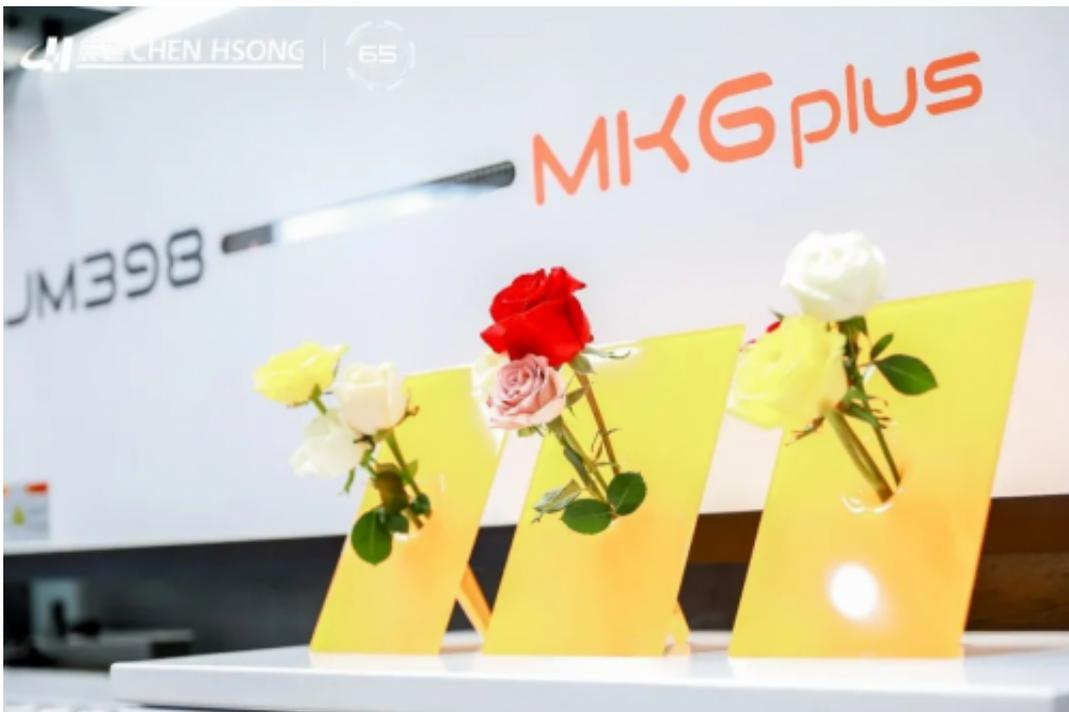
本套方案中，震雄MK6 plus注塑机利用PMMA材料，制作“创意花瓶”，该方案为一出一腔数，制品重量为234g，成型周期约98s。具体方案亮点如下：
