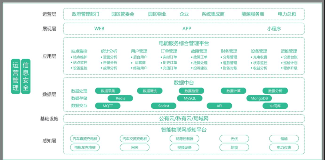
图4 充电桩运营管理平台系统架构
