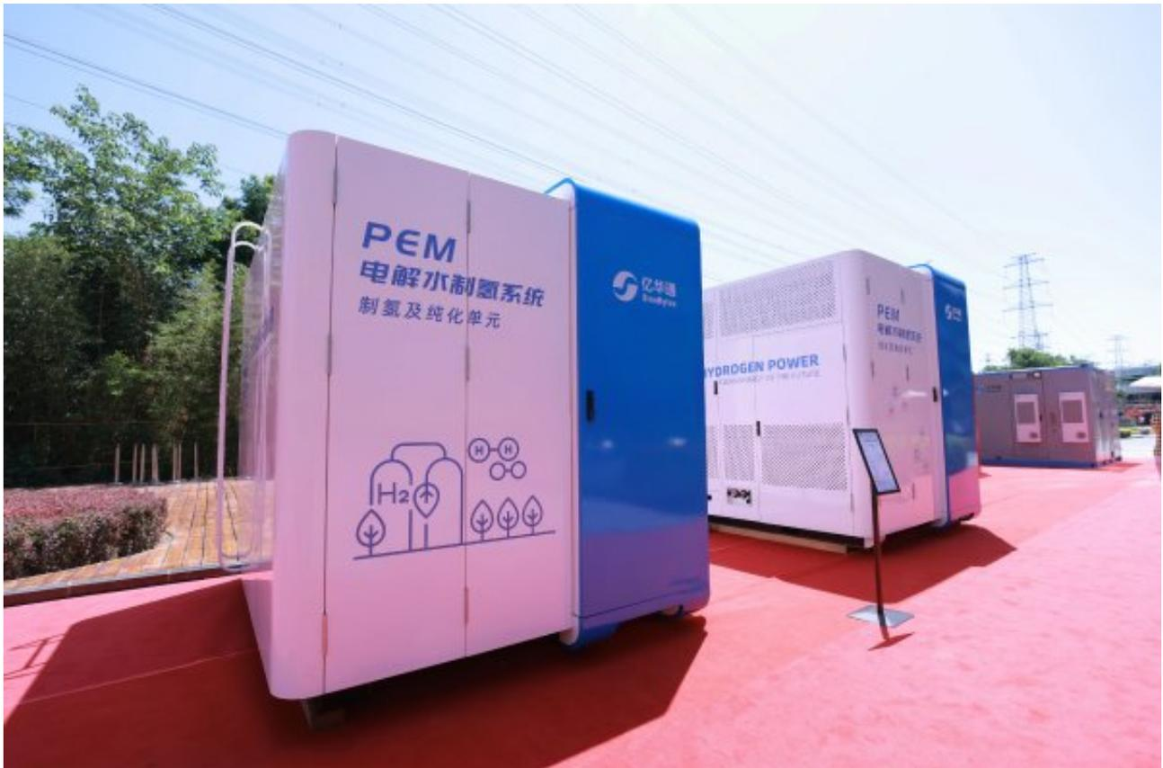
该产品为自主研发，并实现了多项关键性能的突破，具备更快的动态响应速度、更高的电解效率、更高的产氢压力和更小的设备占地面积。
