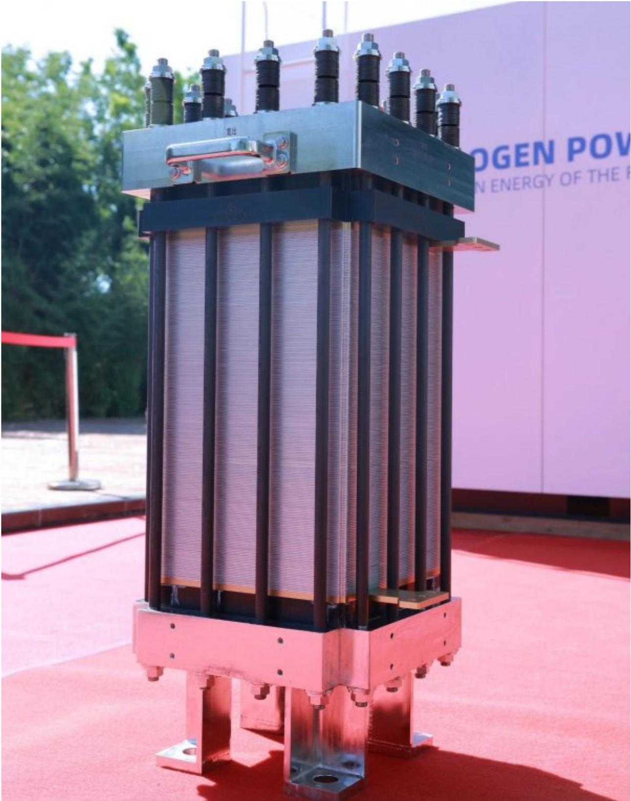
此外，该产品相较其他电解水制氢产品提高了产氢压力，电解槽稳定产氢压力可达到4MPa，结构可承受最高6MPa压差的瞬时冲击，较行业均值提高了50%以上，该设计可以节约储氢过程的能耗，降低氢气在储运环节的成本。
