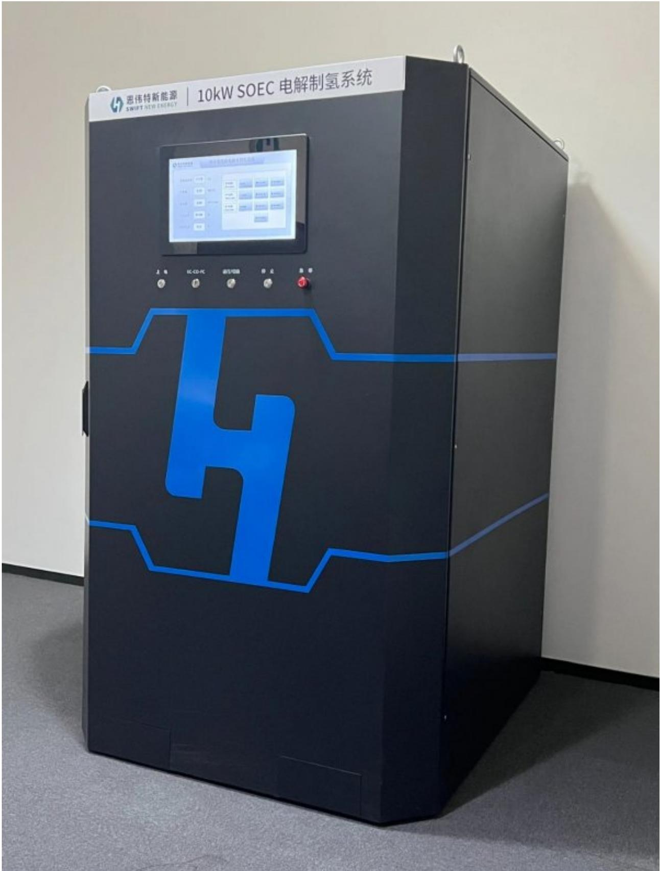
该系统样机在第一代系统设计的基础上进行了全面升级，制氢效率、稳定性和安全性得到全面提升。测试结果显示，系统产氢量达到 $3.23\text{Nm}^3/\text{h}$ ，耗电量 $3.6\text{kWh}/\text{Nm}^3$ ，系统效率大于82%，相关性能指标达到行业领先水平。
