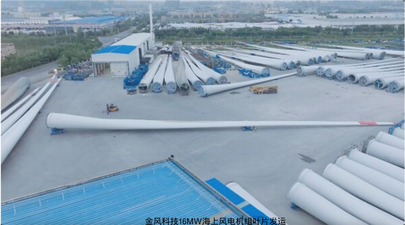
这3支16MW海上风电机组的123米超长叶片从生产工厂出发后，将被运往30公里外的连云港码头，预计将于本月15日左右通过海运送达福建平潭外海的海上风电场进行整机安装。
