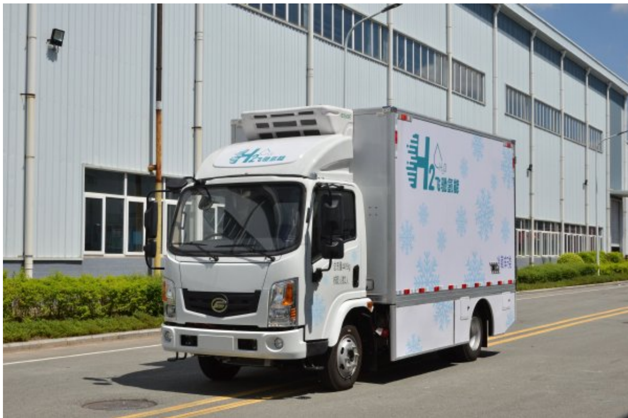
4.5T燃料电池冷藏车，搭载HTWO广州高性能燃料电池系统，动力强劲且性能优越，续航里程(等速法)可达400公
